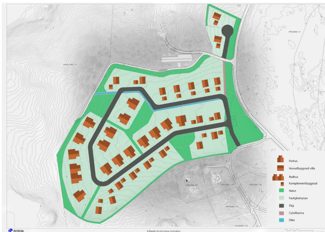
Figur 28. Föreslagen strukturskiss över planområdet. Strukturskiss över föreslagen fastighetsindelning och möjlig placering av byggnader. Strukturskissen visualiserar planområdet vid maximal exploatering. Ritad av Aurum Fastighetsutveckling AB (2022).
