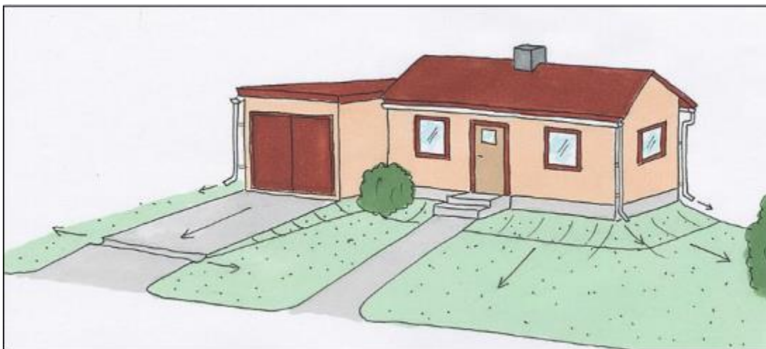
Figur 30. Bild från dagvattenutredning (Geosigma, 2022). Exempel på marklutning bort från byggnad.
