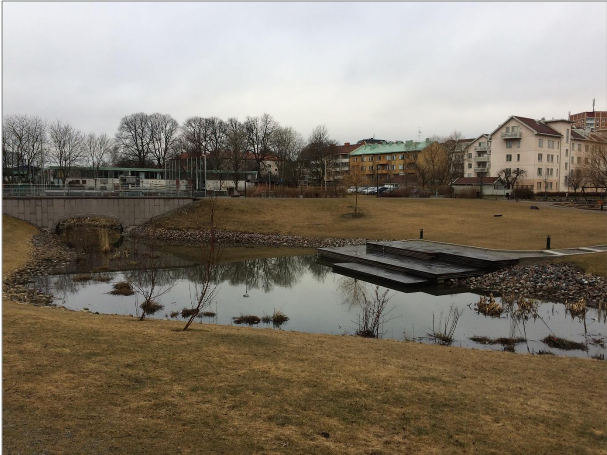
Figur 6-3. Exempelbild av en våt dagvattendamm.
